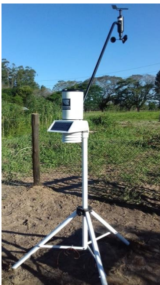
Instalación de Estación Meteorológica. Convenio SENASA.
